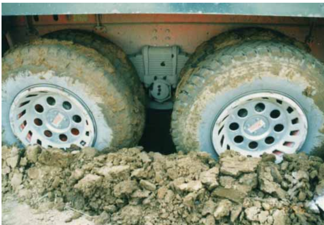
積載量 10 トン、車体総重量 20 トンのダンプが 12 回目で走行不能となる
