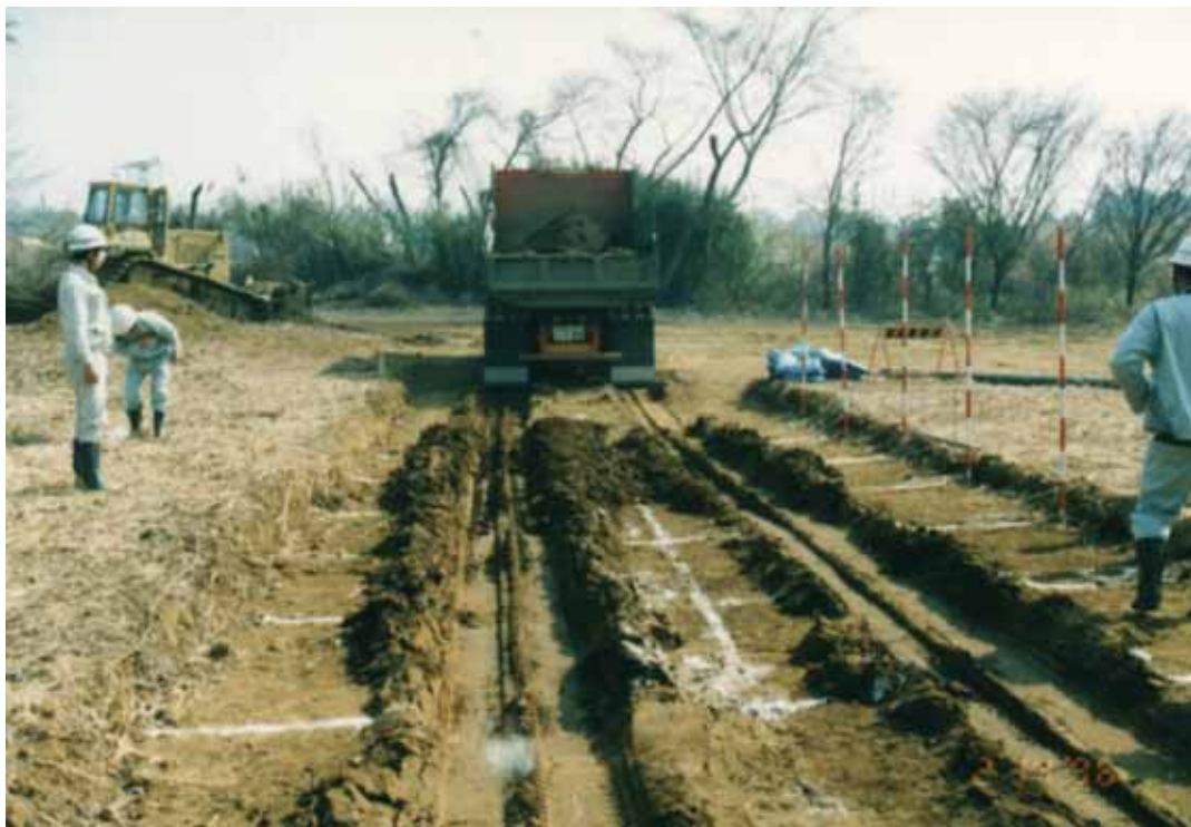
積載量 10 トン、車体総重量 20 トンのダンプが 12 回走行後の路面水分率の高い 2 m ~ 6 m 地点が一番轍が高くなっている。
